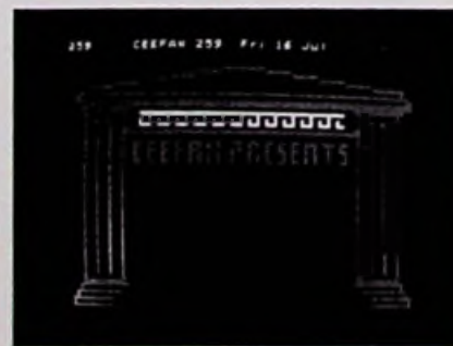
Bild 4. Beispiel einer „Teletext“-Graphik. Die Umschaltung des Decoders im Empfänger auf Wiedergabe graphischer Elemente oder alphanumerischer Zeichen wird mit speziellen Bitmustern (control characters) ausgelöst, die selbst unsichtbar bleiben
