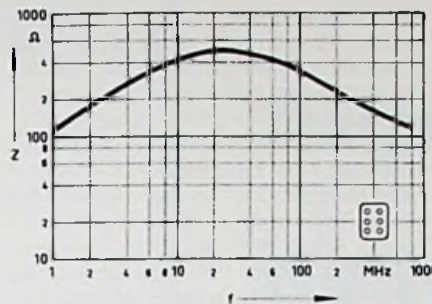
Bild 1.88 Scheinwiderstandsverlauf von Ferrit-Drosselspulen mit 2,5 Windungen bei einer Feldstärke H \leq 10 mA/cm (Siemens)
